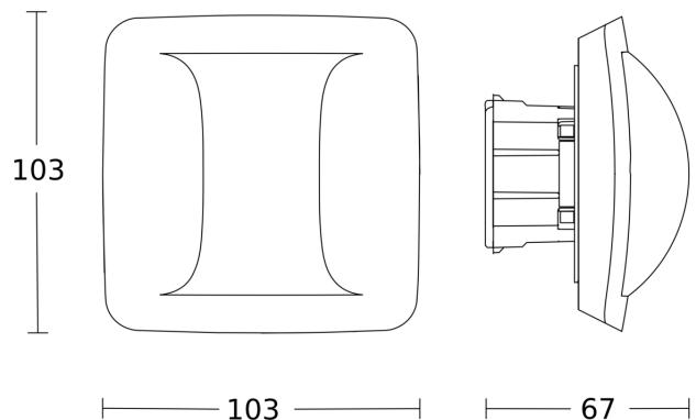
Possibile altezza di montaggio: 2,00 m - 4,00 m
